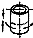
1. d) Cső rögzített PC csőtengely függőleges, varrat haránt helyzetű vagy csőtengely irányú elmozdulás.
